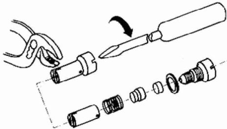
3.6 AUSWECHSELN DER PERBUNANDICHTUNG (6230) DES PUMPENVENTILS
